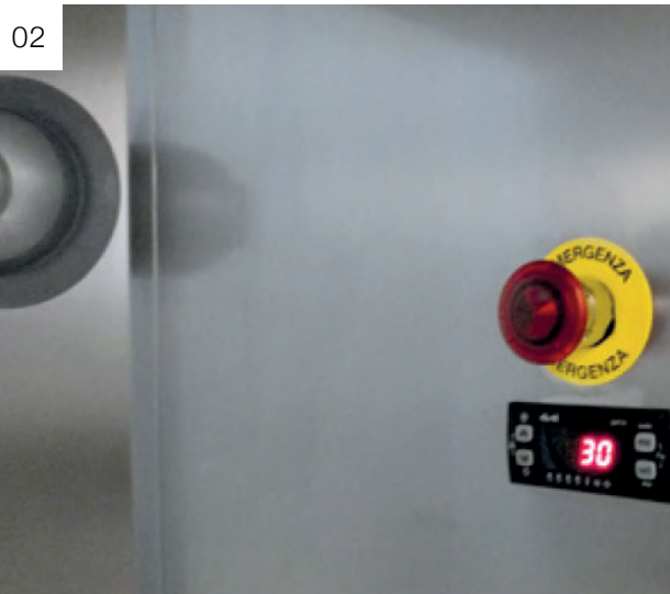
01. Diffusore direzionale ad alta velocità 02. Count down ciclo 03. Semaforo interblocco 04. Pavimento aspirante 01. High velocity directionable diffuser 02. Lcd panel to control 03. Interlock plance 04. Intake floor
